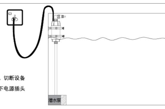
如果插头或插座湿水，则不要拔下电线。切断设备总供电的保险丝或电源断路器，然后拔下电源插头并检查电源插座内是否有水。
